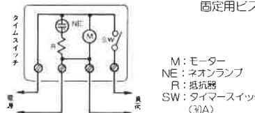
3. 負荷が大きく、電磁開閉器を用いる場合
